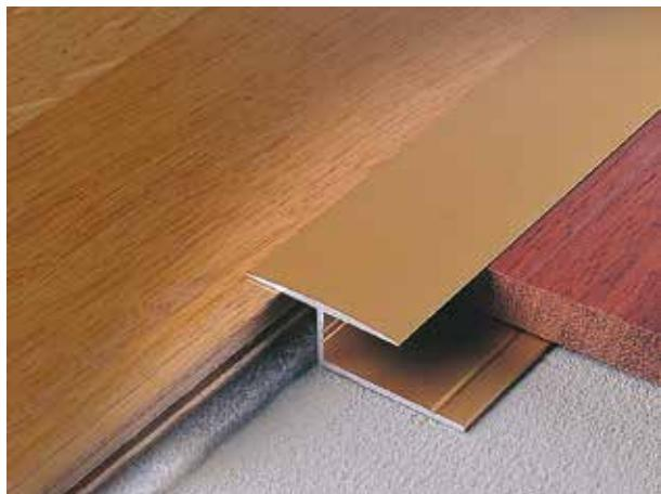
Jonction entre deux sols flottants. La forme et la dimension du profilé permettent la dilatation nécessaire des sols au-dessous. La mince épaisseur visible du profil le rend aussi approprié comme raccord de deux sols au niveau du seuil car il ne crée presque pas d'épaisseur.
